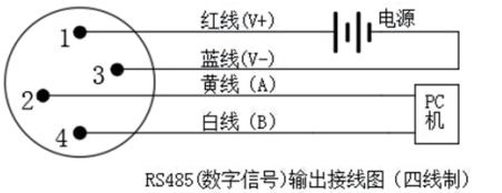
RS485(数字信号)输出接线图（四线制）
