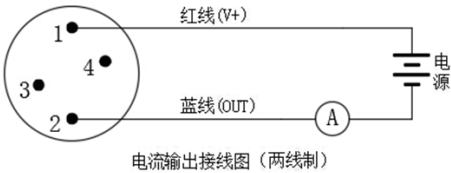
电流输出接线图（两线制）
